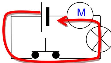
Si la boucle de courant est interrompue à un endroit du circuit alors il n'y a plus de courant nulle part.
