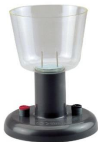
Photographie de l'électrolyseur :
